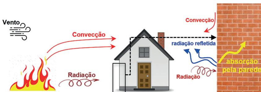
Figura 14. Esquema exemplificativo dos mecanismos de transferência de calor libertado por uma frente de chama.
